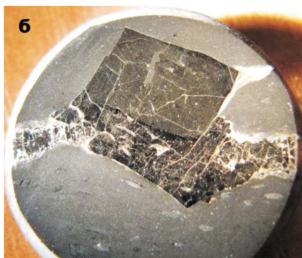
Рис. 4. Метакристалл пирита замещает послойное пирротиновое выделение (а). Реликтовое строение породы выявляется в косом освещении (б). Аншлиф 2296-21.0
