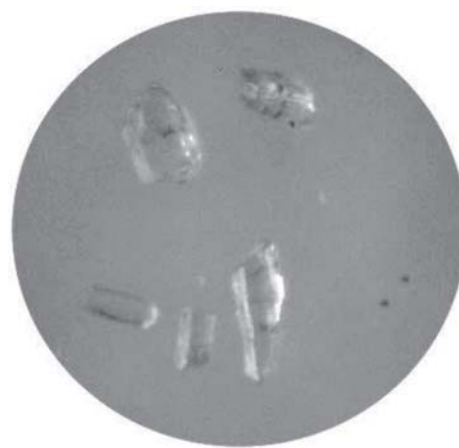
Рис. 2. Обломки кристаллов апатита с фрагментами характерных простых форм. Увеличение: а — 20^{\times}
