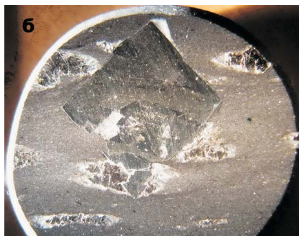
Рис. 5. Метакристалл пирита замещает линзовидные пирротиновые выделения (а). В пирите при косом освещении хорошо видна первичная текстура породы (б). Аншлиф 4446-22.9
