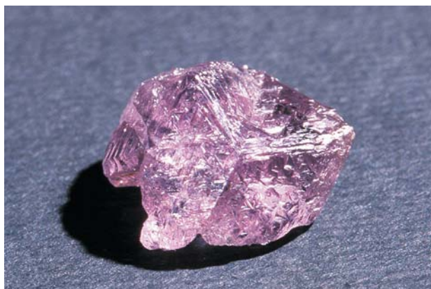
Рис. 2. Двойниковый сросток кристаллов по шпинелевому закону
