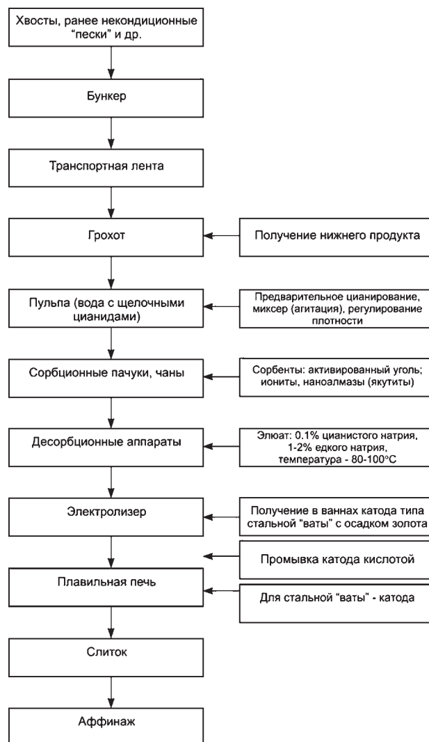
Рис. 4. «Рудная схема» обработки россыпей
