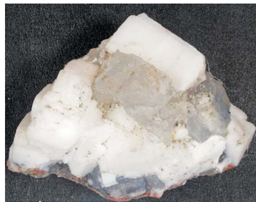
Рис. 4. А — Гигантозернистый бесцветный галит из сростания с гигантозернистым молочно-белым сильвином, контакт пласта «В» с «ВГ», опытная панель, БПКРУ-4; Б — макрофотография образца
