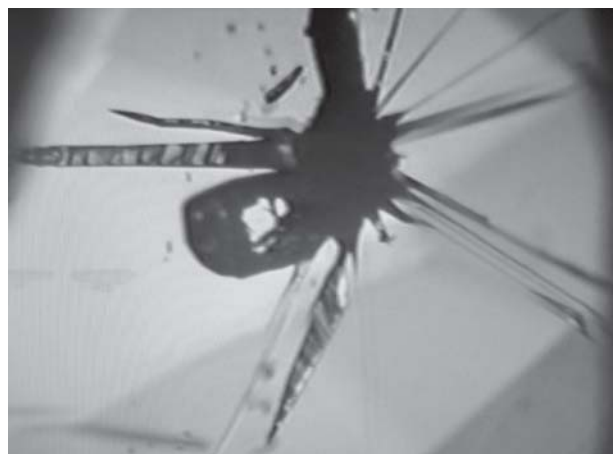
Рис. 3. Типичный дефект кристаллов шпинели в виде минерального включения и радиального пучка полых каналов
