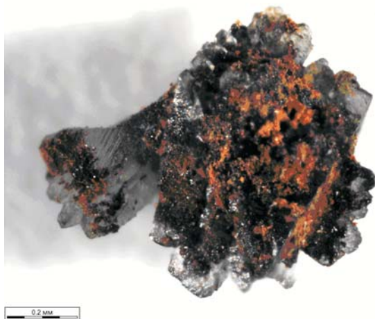
Рис. 4. Агрегат кристаллов кальцита с налетом гидроокислов на поверхности
