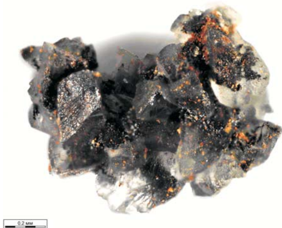
Рис. 3. Агрегат прозрачных зерен кальцита
