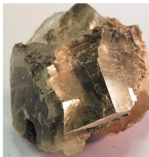
Рис.3. А — Шпатовый галит отобранный из участка перекристаллизации в контакте с разрывным нарушением (лежачий бок), слой 22 ПдКС, Б — макрофотография образца
