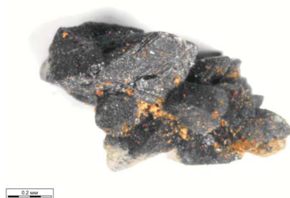
Рис. 1. Зерна кальцита с идиоморфными гранями и ступенчатой поверхностью спайности
