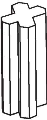
Рис. 3. Восстановленный вид двойника ставролита по Дэна — двойникование по (230) и (−130) дают один результат
