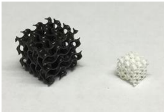
Рис. 4. Макропористый материал до обжига, представляющий собой композит «полимер/окрашенный порошок фосфата кальция» (слева) и керамический материал после обжига (справа). Длина ребра образца до обжига – 11,6 мм, после обжига – 6,1 мм.
