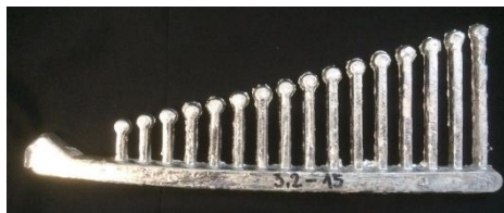
Рис.1. Пример отливки «Арфа» из сплава Al-6Ca-0,3Sc-0,6Si
