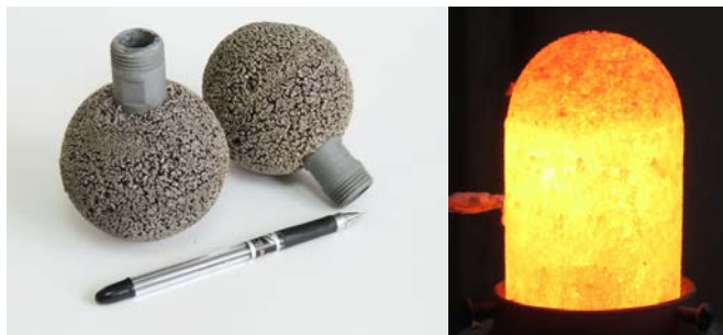
Рис. 1. Пористые Ni–Al горелки, получаемые методом СВС.
