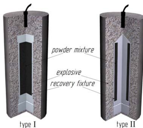
Рис.1. Схемы ударно-волнового компактирования
