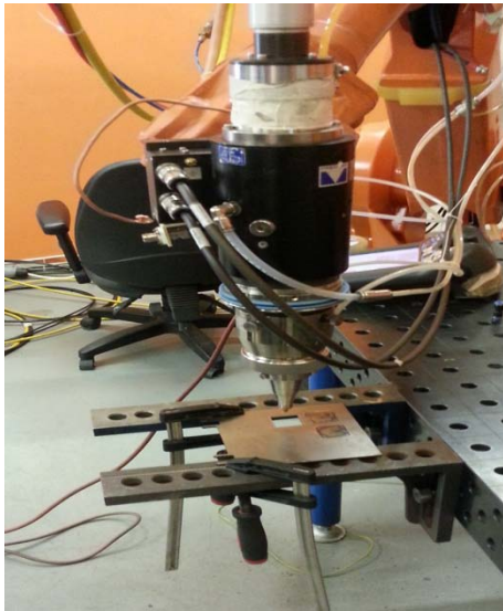
Рис.1. Лазерная технологическая головка (а). Рез металла оптикой Precitec и РФ (б).
