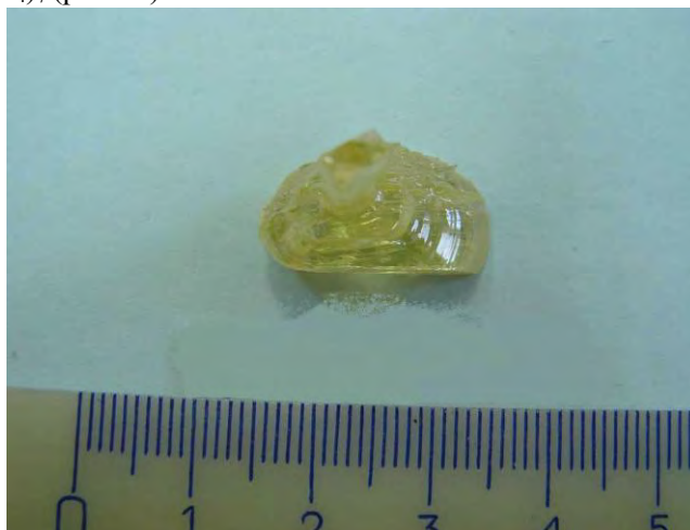
Рис. 2. Кристалл \text{Li}_8\text{Bi}_2(\text{MoO}_4)_7 , выращенный из раствора в расплаве эвтектической смеси (47 мол. % \text{MoO}_3 + 53 мол. % \text{Li}_2\text{MoO}_4 )
