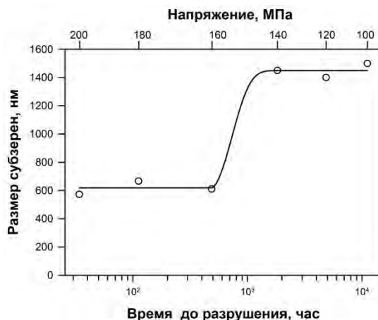
Рисунок 2 - Изменение размера субзерен после испытания на длительную прочность при различных напряжениях 100-200 МПа (T=650°C)
