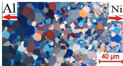
Рисунок 2. Зеренная структура интерметаллида Ni_2Al_3 (отжиг 720\text{ }^{\circ}C , 10 ч)
