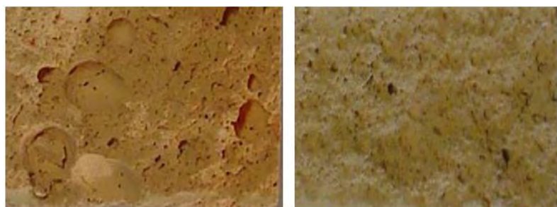
Рис.2. Фотографии поверхности исходного образца (слева) и после отжига при температуре 1000 °С в течении 2 часов на воздухе (справа). Увеличение 100 x .
