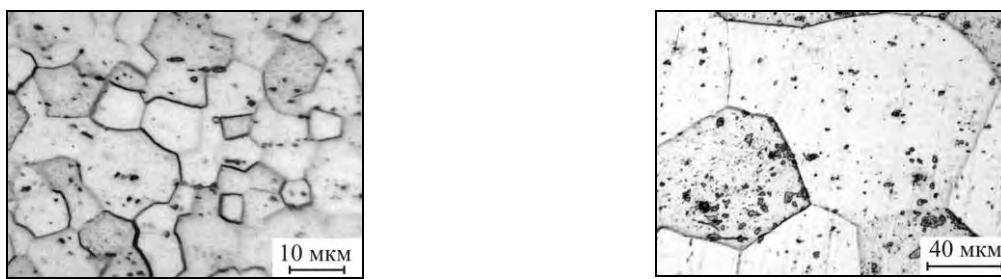
Рис. 1. Структура сплавов на основе TiNi после отжига 700 °С, 1 час (а, б) и 1100 °С, 1 час (в, г): а, б – сплав №1; в, г – сплав №2.
