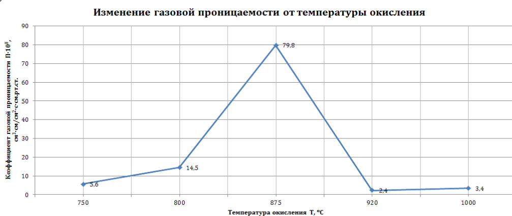
Рис.1 Зависимость средних значений коэффициентов газовой проницаемости кислорода через образцы рутила, полученных при различной температуре окисления титановых преформ.
