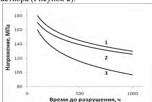
График 2. Длительная прочность монокристаллических ЖНС при температуре испытаний 1100 °С: 1 – ВЖМ6; 2 – ВЖМ4; 3 – ЕРМ-102.
