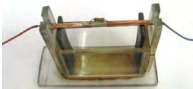
Рис.1. Фотография экспериментальной коллоидно-химической ячейки для снятия спайковых выделений тока самоорганизации оксигидратных гелей
