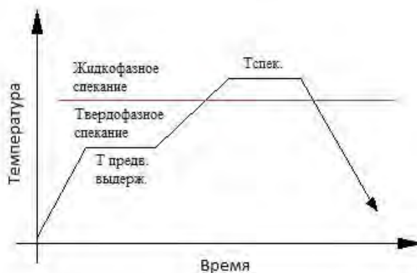
Рис.1 Процесс двухстадийного спекания образцов твердого сплава
