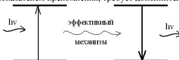
Рисунок 3. Грубая схема переизлучения в рассеивающей свет точке ФРПС в монокристалле НЛ.
