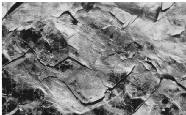
Рис.2. Рв. Объемная картина места усталостного разрушения, \times 50
