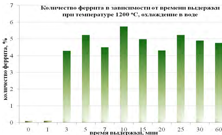
Рис. 1. Количество феррита в зависимости от времени выдержки при температуре 1200 °С (охлаждение в воде) стали 05X22AG15N8MFL.
