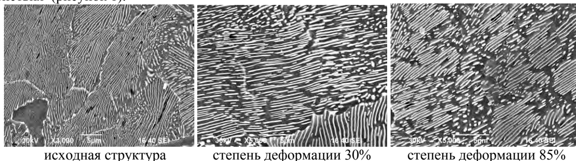
Рисунок 1. Микроструктура стали марки 75 при различной степени деформации кручением в ходе совмещенного процесса деформационного наноструктурирования
