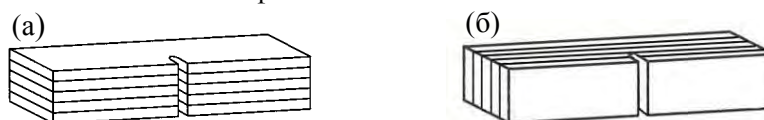
Рис. 1. Образец для испытаний на ударный изгиб с «разветвляющим» (а) и «тормозящим» (б) трещину расположением поверхностей соединения.
