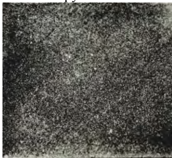
Рис. Микроструктура горячекструированного прутка, изготовленного из полученных при \tau_r = 180 мин гранул порошковой композиции ПАС-3 ( \times 500 )
