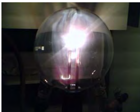
Рис.1. Нагрев металлической преформы в реакторе
