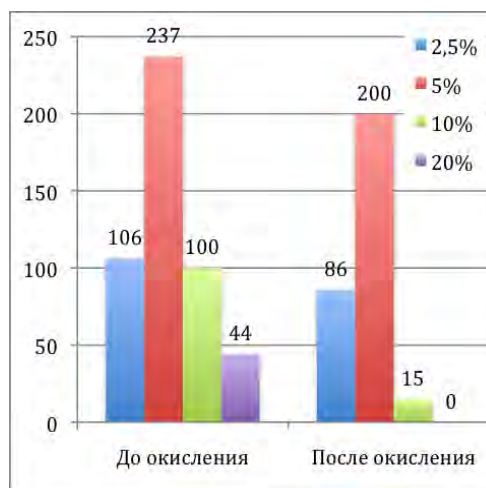
Рисунок 2. Изменение предела прочности на изгиб до и после окисления при температуре 750°C в течение 100 часов.
