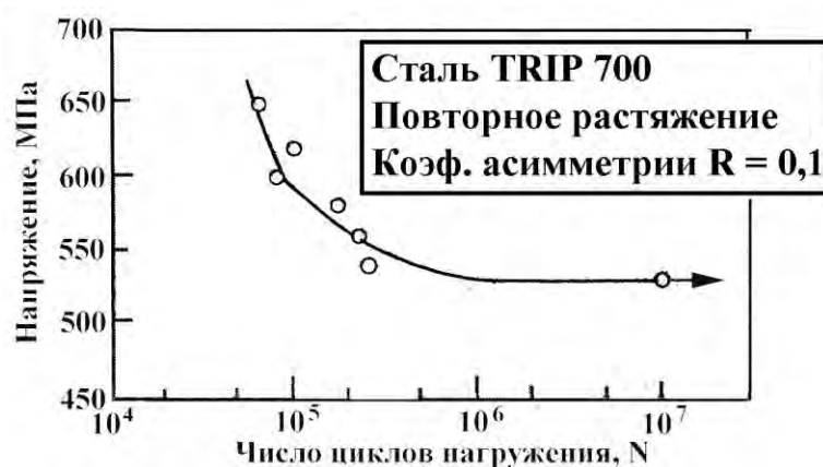
Рис. 1. Кривая усталости стали TRIP 700
