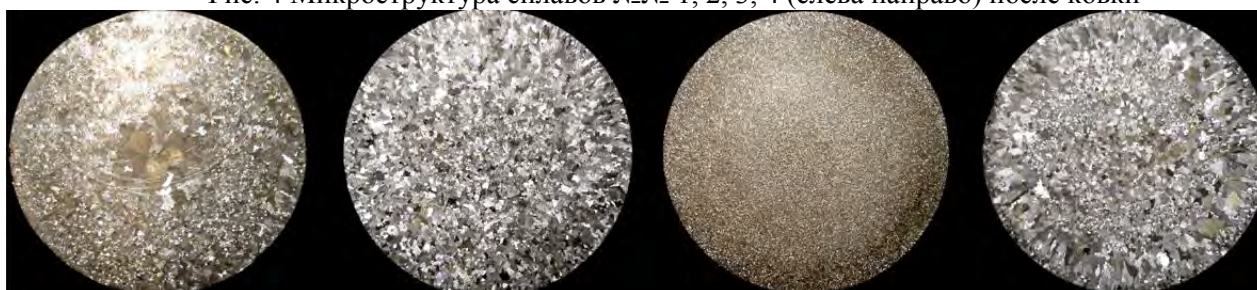
Рис. 5 Макроструктура литых сплавов №№ 5, 6, 11, 12 (слева направо)
