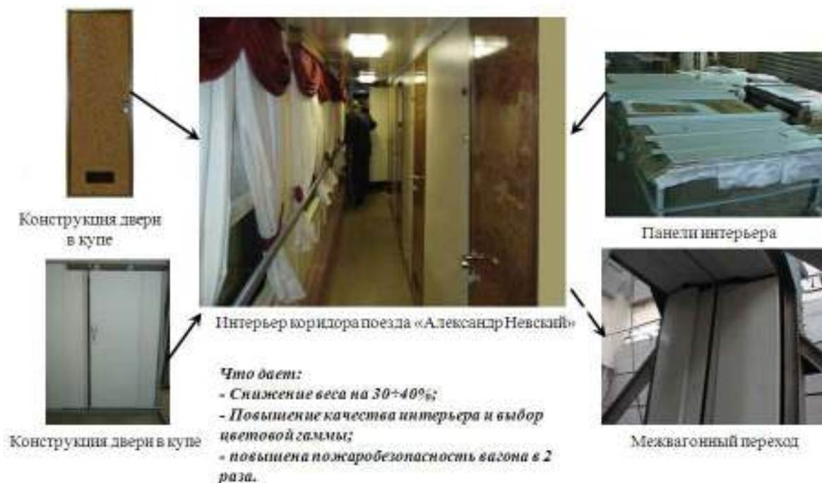
Рис. 2 – Стеклопластиковые панели интерьера железнодорожных вагонов
