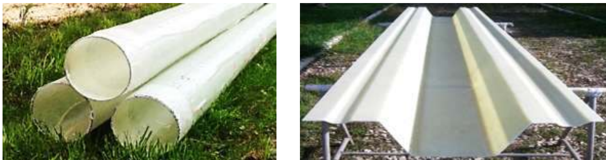
Рис. 8 – Композитные шпунты (круглого сечения на основе плетеного рукава (диаметром до300 мм), и корытного типа (шпунт Ларсена) на основе равнопрочной стеклоткани)
