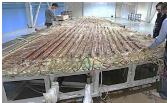
Рис.1 – Схема сборки технологического пакета для вакуумной инфузии [9]
