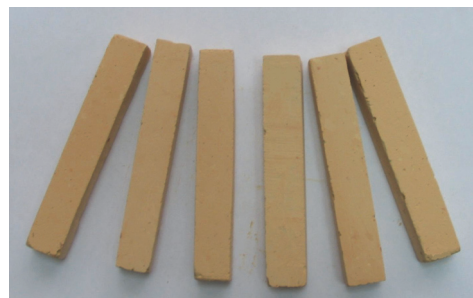
Рис. 1. Исходные образцы пенодиатомитовой керамики размером 25×30×120 мм 3 .
