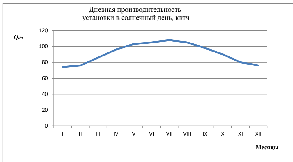
Рис.3 Дневная производительность установки в солнечный день, кВтч
