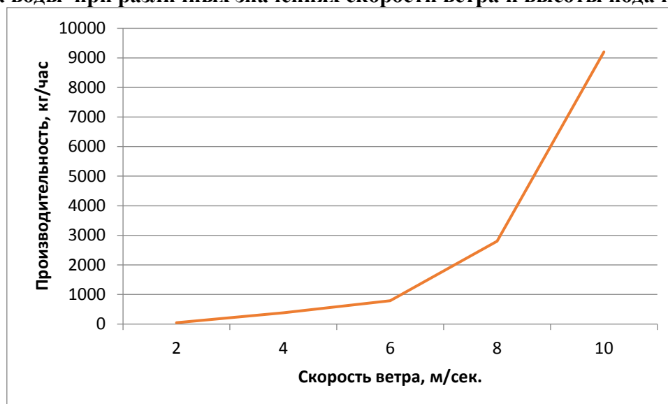
Рис. 2. График производительности ветронасоса зависимости от скорости ветра при подаче воды на высоту 40м
