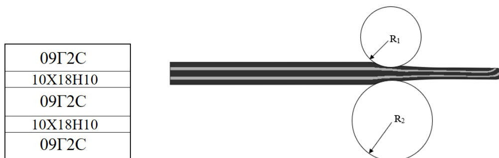
Рис. 1. Схема сборки (а) и АП (б) КМ
