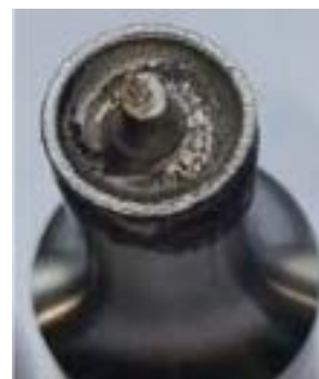
Рис. 1. Общий вид волновода из титанового сплава ВТЗ после эксплуатации
