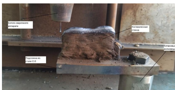
Рис 1. Вид крепления к волноводу подложки с полученной на ней по технологии послойной наплавки стенкой
