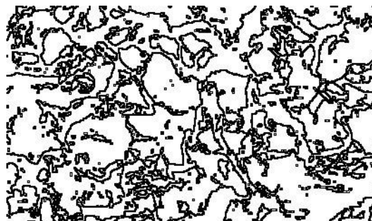
Рис. 1. Изображение распределения границ между фазами конструкционного материала
