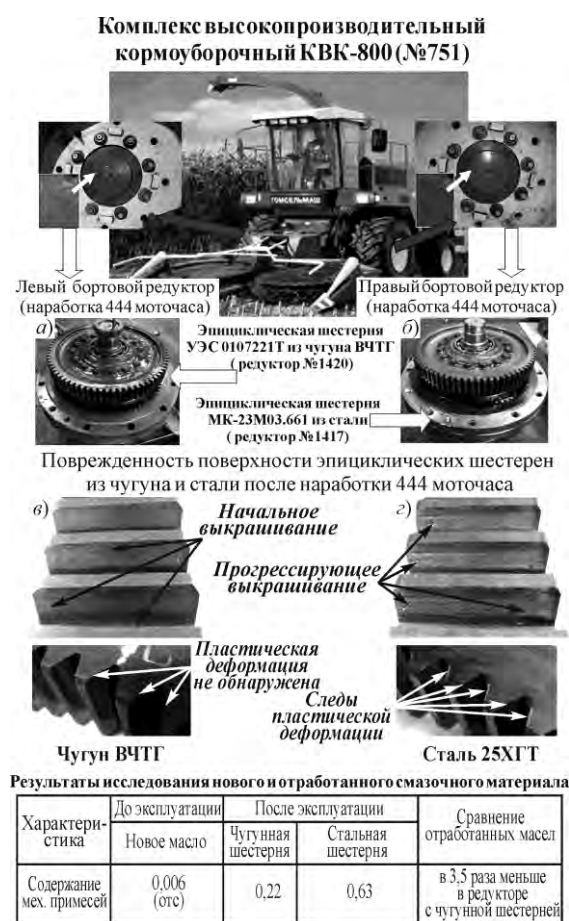
Рис. 1. Общий вид комбайна КВК 800 (№751) и эксплуатационные повреждения зубьев колес из чугуна (а, в) и стали (б, з)
