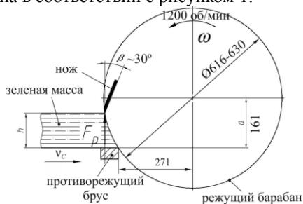
Рис. 1. Схема работы режущего барабана комбайна
