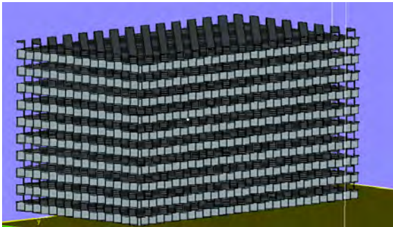
Рис. 3 Модель наполнителя катализатора (слева) и блок для его PIV-исследования (справа)
