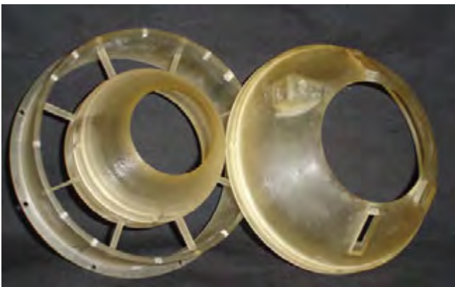
Рис. 4. Экспериментальный образец горелки с прозрачными окнами в наружной части для PIV-исследования потока в внутренней зоне
