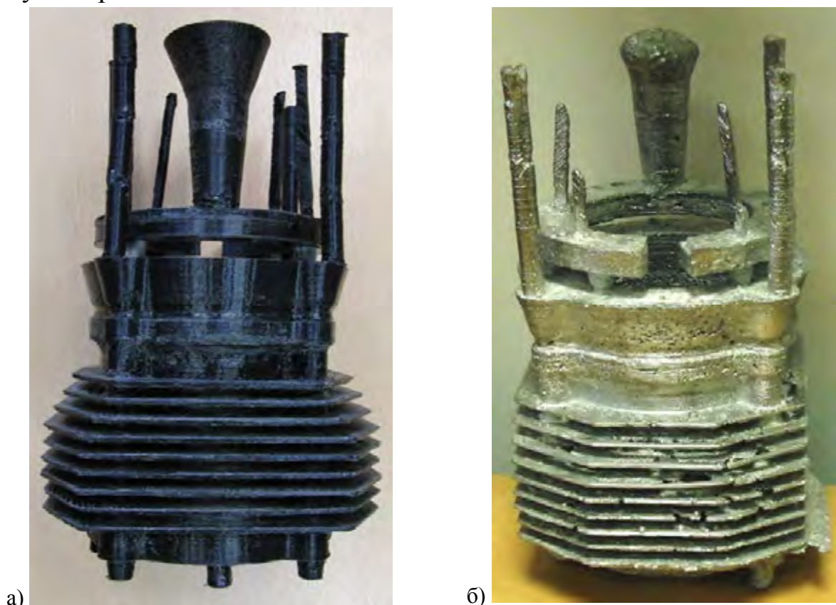
Рис. 2. Отливка с литниково-питающей системой: а) пластиковая модель блока в сборе; б) залитый блок.
