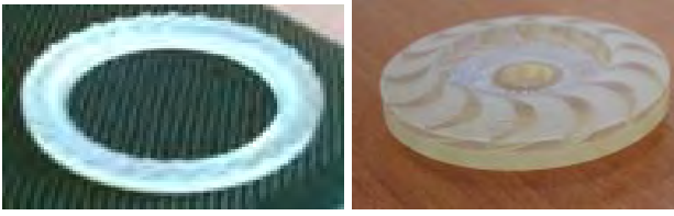
Рис. 1. Образцы центростремительного микротурбинного привода: сопловой аппарат (слева) и цельновыращенное закрытое рабочее колёсо (справа)
