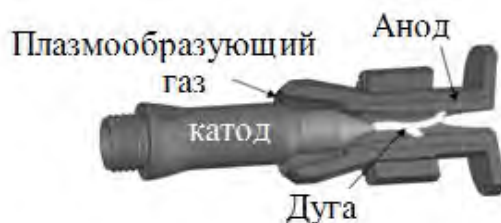
Рис. 1. Принцип работы плазмотрона
