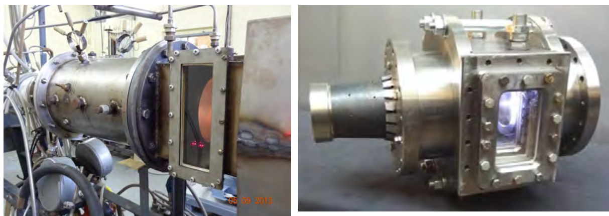
а) измерения с помощью ЛАД-056С; б) отсек для испытаний при высоком давлении;
