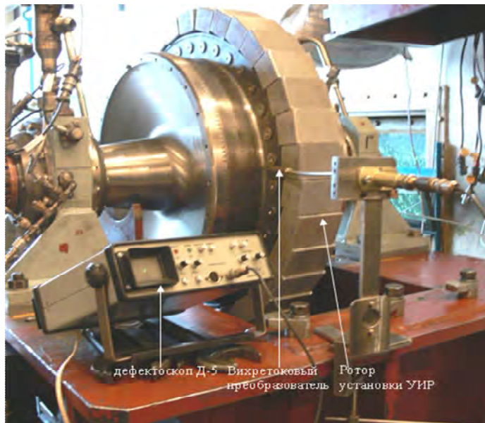
Рис. 4. Оборудование для проведения вихретокового контроля наружной поверхности задней реборды в условиях установки УИР-3
