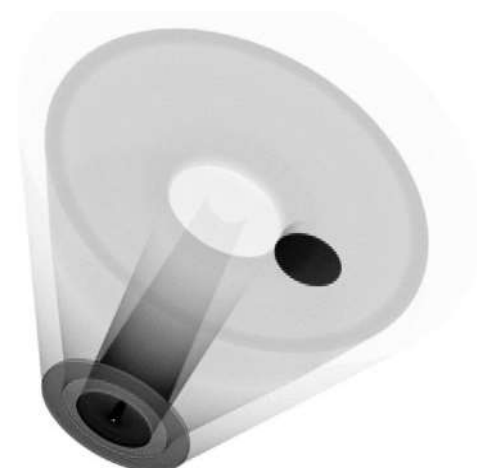
Рис. 1. Схема расположения подложки в потоке распыления
