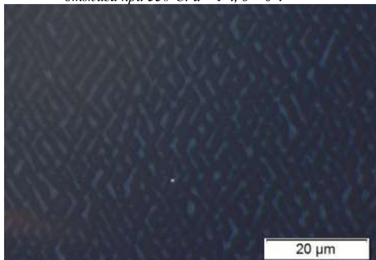
Рис. 2. Пластинчатые выделения k_1 -фазы, образующиеся при отжиге протонообменных слоев в кристаллах ниобата лития
