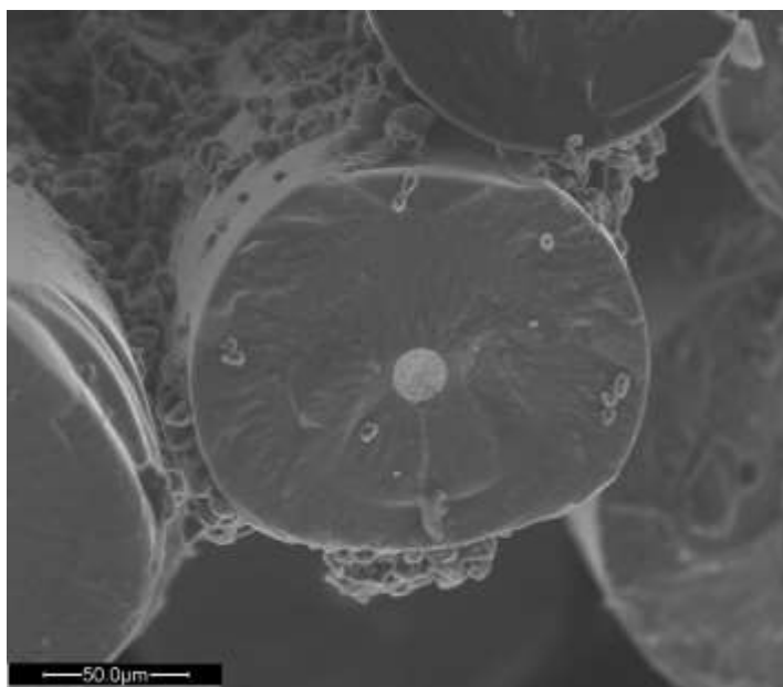
Рисунок 1. Микрофотография волокна ядерного волокна SiC.
