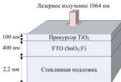
Рис. 1. Схематичное изображение лазерного отжига пленки прекурсора \text{TiO}_2
