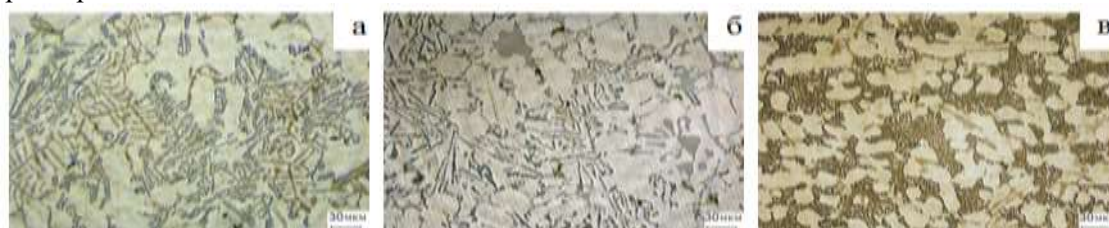
Рис. 2. Структура сплава АК12М2МгН до (а) и после введения 2% (б) и 3% (в) SiC- \alpha -Al 2 O 3
