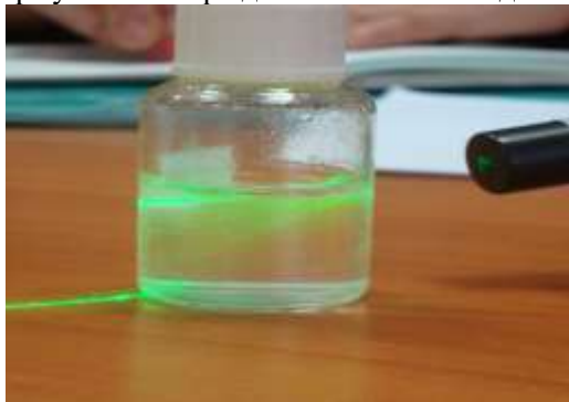
Рис 1. Пример опалесценции в объемном материале на стадии формирования влажного геля.
