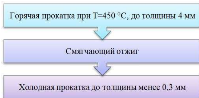
Рисунок 1 - Схема деформационной обработки слитки в литом состоянии
