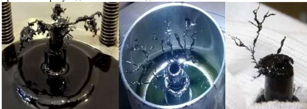
Рис.3 Древоподобные структуры в продукте гидроконверсии, масле И-50А, масле С-9
