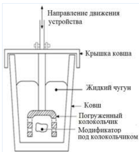
Фиг.1 Техника ввода модификатора под колокольчиком
