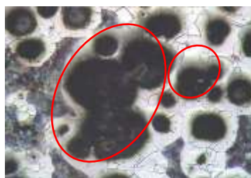
Фиг.3 Уменьшение сферичности графитовых включений в процессе их агломерации в жидком металле. Сплав ЧШГ-2 (35 мин./1246°C). МО. 100х.
