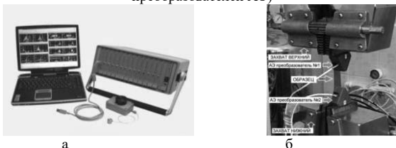
Рис. 2. Акустико – эмиссионная диагностическая система СДС1008 (а) и схема крепления преобразователей АЭ (D1-D2) на образце в захватах испытательной машины Instron 3382 (б).
