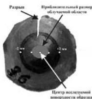
Рис.1. Поверхность деформированного КВД образца при рентгеновской дифракционной съемке.
