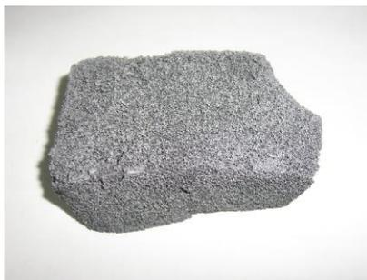
*Рис. 4 Композиционный высокотемпературный сотовый карбид кремния для рассеивания и отражения тепловых потоков.*
