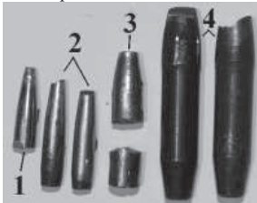
Рис. 2. Разрушение сердечников при испытании
