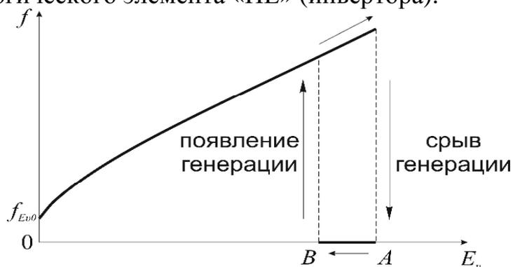
Рис. 2. Зависимость частоты колебаний от освещенности с участком гистерезиса
