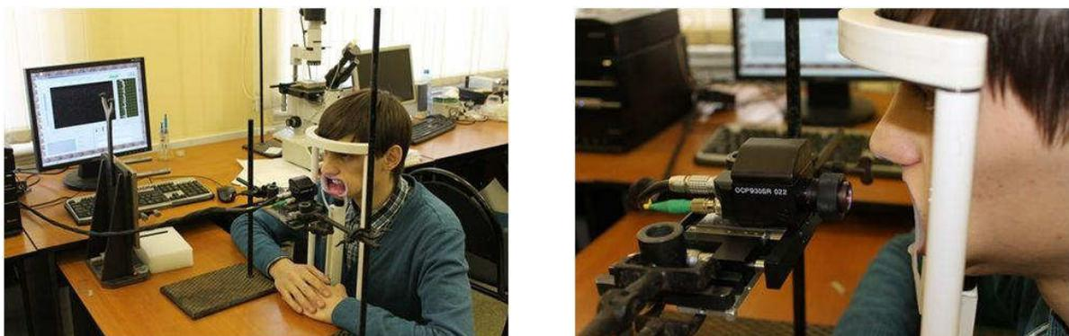
Рис. 1. Исследование состояния адгезивных интерфейсов с использованием низкокогерентного лазерного компьютерного томографа Spectral Radar OCT Imaging System OCP 930 SR 022
