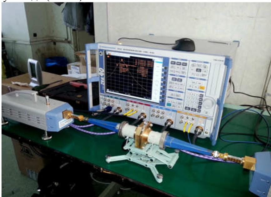
Рис. 4. Измерительная установка. Векторный анализатор Rohde&Schwarz ZVA-40, преобразователи частоты Rohde&Schwarz WR06 ZVA-Z170, металлодиэлектрический лучевод.
