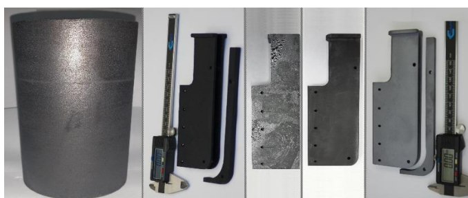
Рис. 2. Изготовление детали сложной геометрической формы из композиционного SiC материала с защитным SiC покрытием
