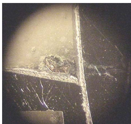
Рисунок 2 – Макрошрифты защитного покрытия после высокотемпературных испытаний
