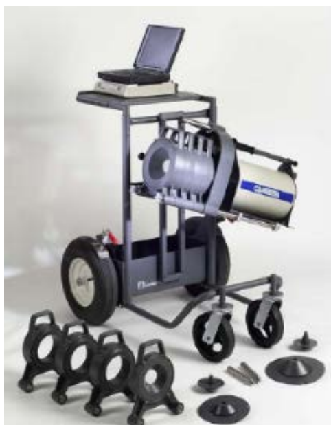
Рисунок 3 - Гамма-спектрометрическая система ISOCS
