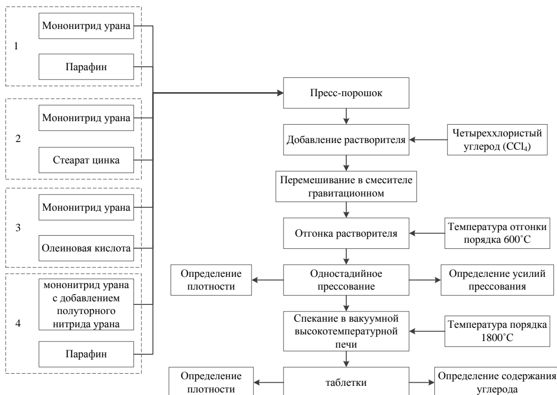
Рисунок 1. Схема экспериментов по процессам прессования порошков нитридов урана.
