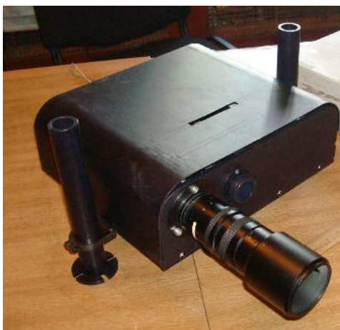
Рисунок 2 – Цифровой голографический интерферометр ЦГИ-2М (слайд 1)
