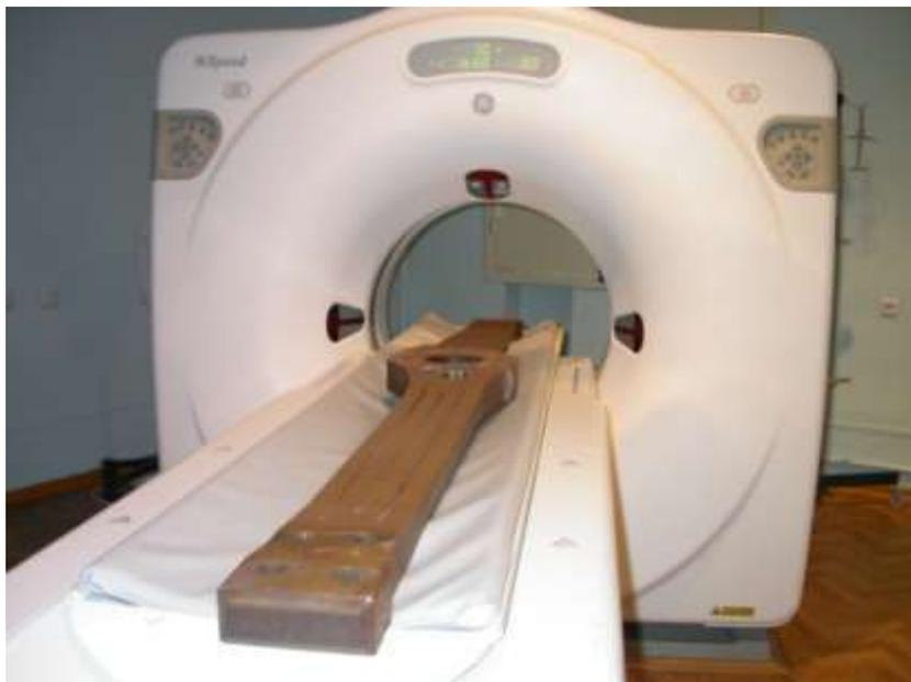
Рисунок 3 – Диагностика втулки НВ на СКТ
