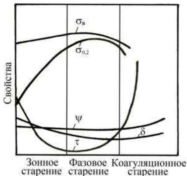
Рисунок 4 – Изменение характеристик сплавов 1901 и 1903 при переходе от «зонного» к «фазовому» и «коагуляционному» старению
