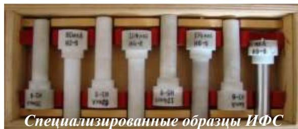
Рисунок 9 – Прибор ИФСС и комплект образцов ИФС
