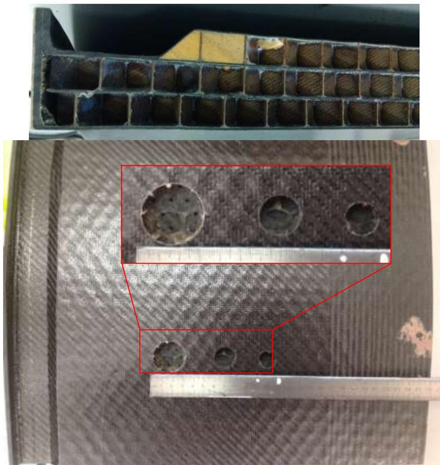
Рисунок 1 – Искусственные дефекты, имитирующие расслоения и непроклеи в конструктивно-подобном образце корпуса переднего мотогондолы двигателя (дефекты получены путем фрезерования отверстий различного диаметра на различную глубину)
