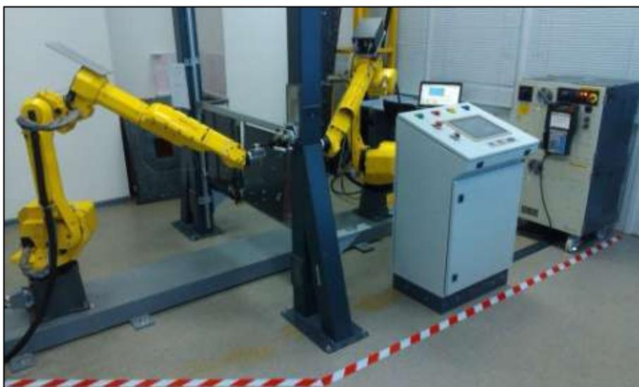
Рисунок 6 – Макет автоматизированного комплекса для ультразвукового неразрушающего контроля качества деталей и агрегатов из ПКМ
