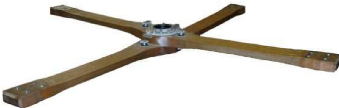
Рисунок 2 – Общий вид втулки НВ вертолета «Ансат»
