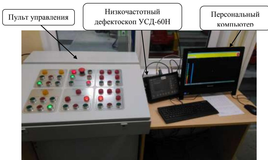
Рисунок 5 – Рабочее место оператора
