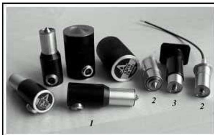
Рисунок 4 – Внешний вид УЗ преобразователей с СТК
