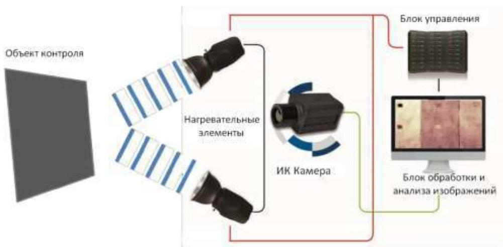
Рис. 1 – Схема контроля методом активной термографии
