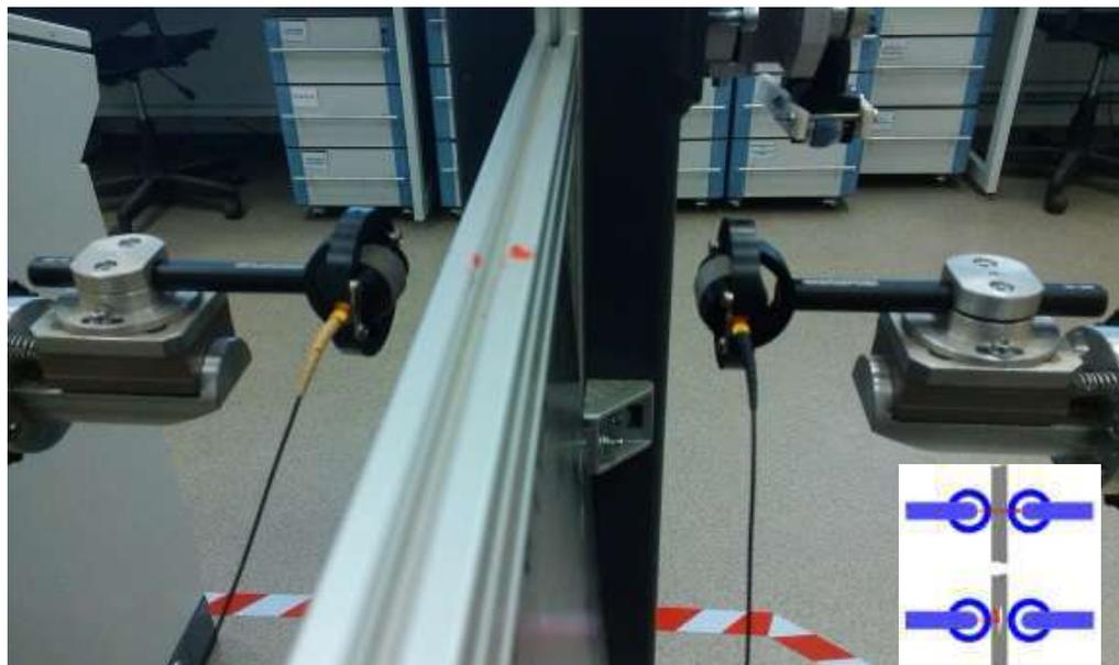
Рисунок 7 – Автоматизированный теневой ультразвуковой контроль изделий из ПКМ роликовыми катящимися преобразователями
