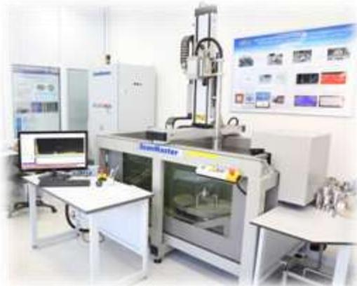
Установка для автоматизированного контроля ScanMaster LS-500LP
