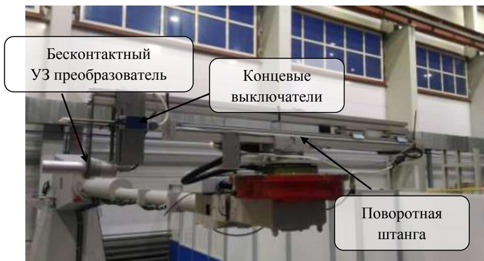
Рисунок 2 – Узел внутреннего датчика
