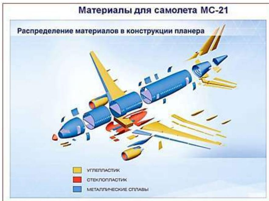
Рисунок 1 – Применение ПКМ в конструкциях самолета МС-21
