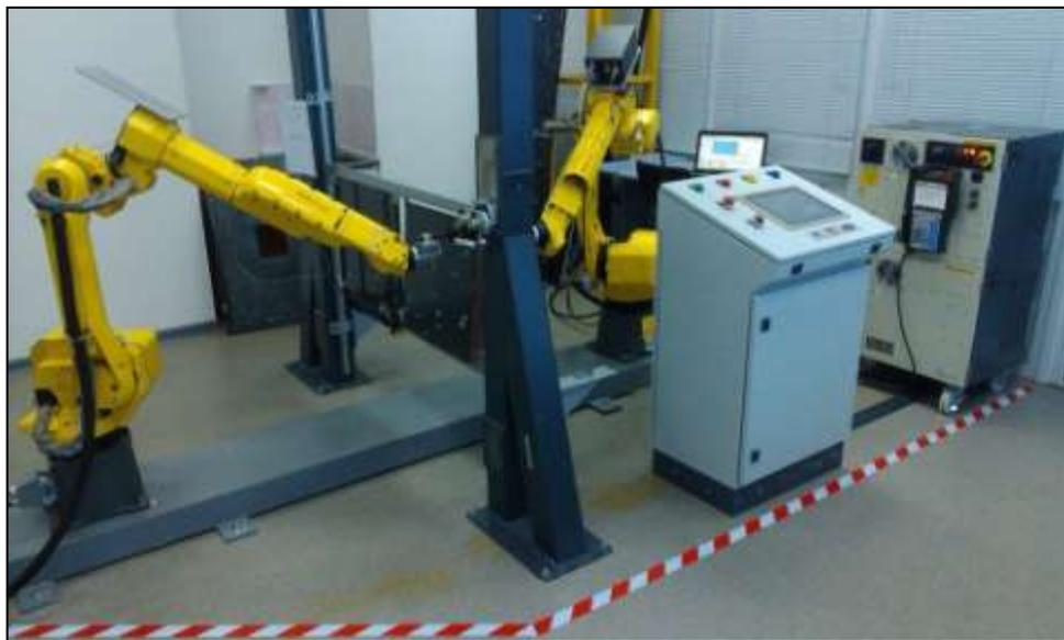
Рисунок 4 – Полномасштабный макет автоматизированного комплекса контроля качества деталей и агрегатов из ПКМ «МАК-ПКМ»
