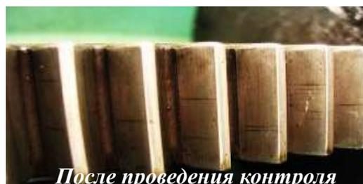
Рисунок 8 – Магнитопорошковый контроль изделий сложной формы
