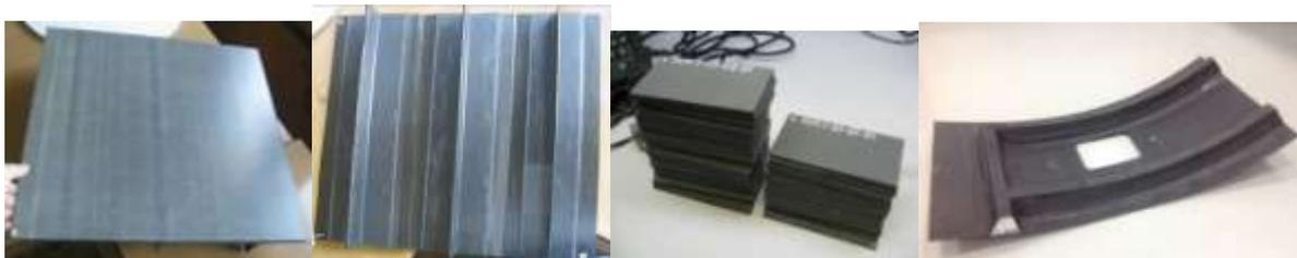
Рисунок 2 – Конструктивно-подобные образцы из ПКМ
