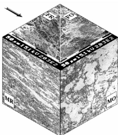
*Рис.1 Аксонометрическое представление структур, выявленных при x200 на образцах после 3 циклов прессования. Обозначения: поверхности шлифов - **М** и изломов - **Ф**, ориентированные перпендикулярно - **О** и параллельно - **Р** направлению деформирования, показанному стрелкой.*
