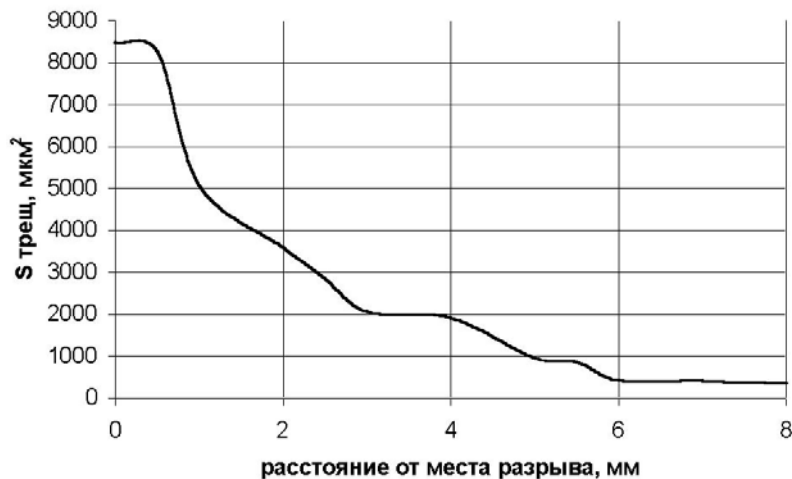
Рис. 6. Повреждаемость стали N1 в разных точках от места разрыва. Схема «б» при температуре 600°C.
