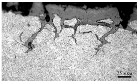
Рис. 5. Микроструктура поверхностного слоя стали 1, испытанной по схеме «б» при температуре 700°C, на расстоянии 5 мм от места разрыва.
