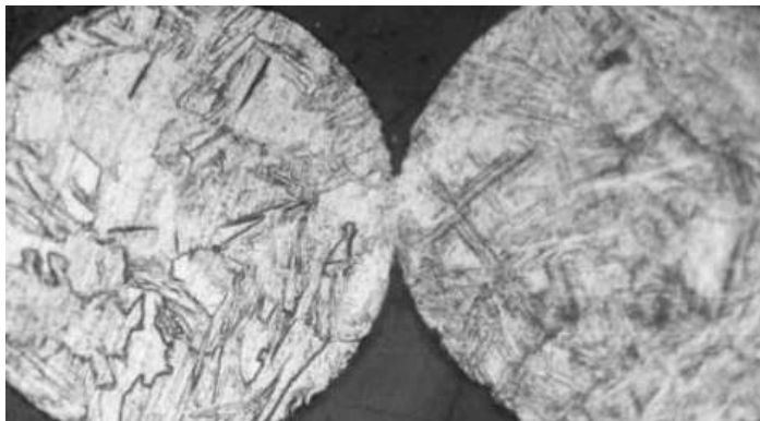
Рис. 3. Микроструктура частиц заготовки, полученной методом ЭИС, \times 150
