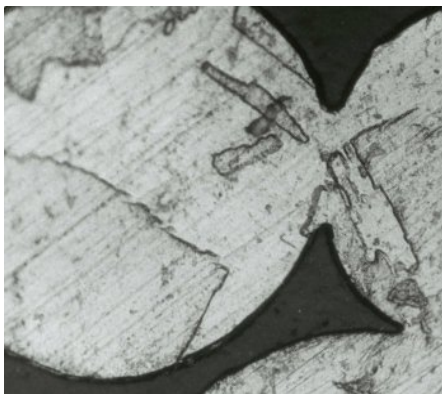
Рис. 4. Микроструктура частиц образца, полученного методом ЭИС с последующим спеканием в вакууме, \times 200
