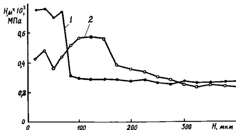
Рис. 3. Зависимости изменения микротвердости H_\mu по глубине поверхностного слоя H после электромагнитной наплавки (1) и последующего поверхностного пластического деформирования (2) покрытия порошком FeV
