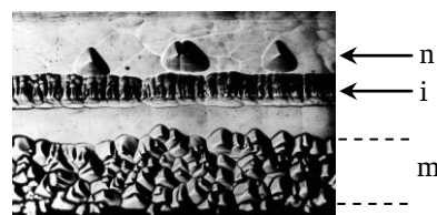
Рис. 2. Микрофотография селективно травленого скола эпитаксиальной структуры \text{Ge(B)}/\text{Ge} (111) при t > c/2 . Наблюдаются дислокации несоответствия (i) и дислокации в подложке и пленке в нейтральных m и n системах. Пунктиром отмечена область перемещения нейтральной m с ростом толщины пленки.
