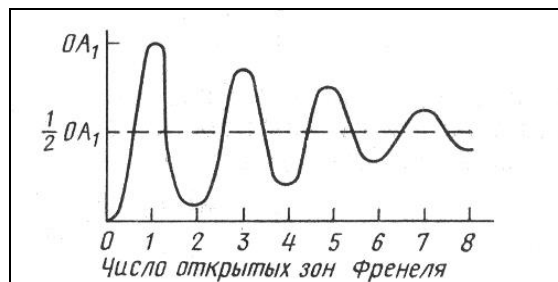
Рис. 4. Зависимость величины результирующей амплитуды рассеяния OA_1 от числа открытых зон Френеля
