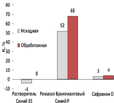
Рис. 2. Значения удерживания модельных красителей исходной и обработанной ПТМСР мембран при трансмембранном давлении 30 атм
