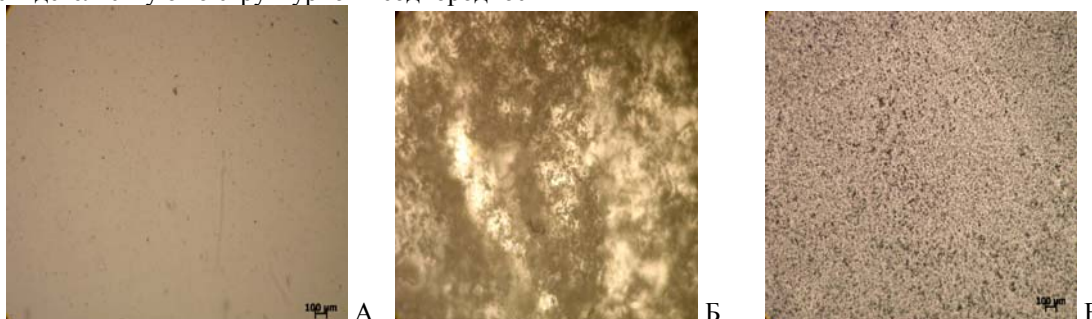
Рис.1. А –полиуретан, Б-полиуретан с неорганической фазой (5%), В- полиуретан с неорганической фазой (10%) гетерогенности синтезированных гибридных полимеров.
