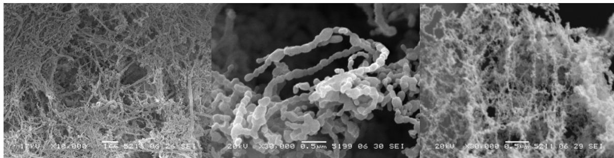
Нановолокна оксида алюминия (а), диоксида титана (б), диоксида кремния (с)
