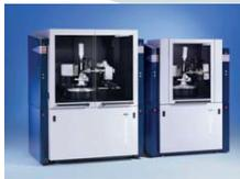
D8 QUEST и D8 VENTURE — современные инструменты рентгеновской кристаллографии. Все компоненты дифрактометров, включая детектор, гониометр, источники излучений и программное обеспечение основаны на самых современных достижениях.
