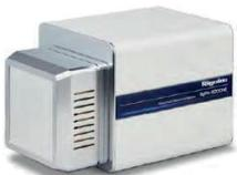
Новый детектор **HyPix-6000HE** обладает многими преимуществами в области измерения данных монокристаллов. Речь идет о детекторе прямого счета, который не требует сцинтиллятора. Функция точечного распределения отражения определяется не свечением сцинтиллятора, а размером пиксела. Пиксел 100  $\mu\text{m}$  позволяет уменьшить размер отражения и свести к минимуму перекрытие отражений и зону, в которой накапливается фон.
