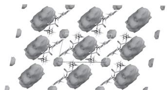
В структуре I молекулы неорганических коформеров не образуют контактов друг с другом и полностью окружены полостями, занятыми кластерами  $(H_2O_2)_5$  и отдельными неупорядоченными молекулами перекиси. Таким образом, данная структура может рассматриваться как «твердый раствор» органического коформера в перекиси водорода.
