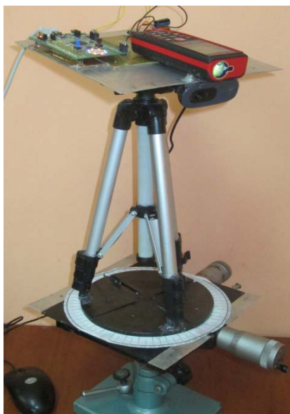
Рис. 2. Макетный образец лазерно- телеметрического устройства с угловым и линейным сканированием
