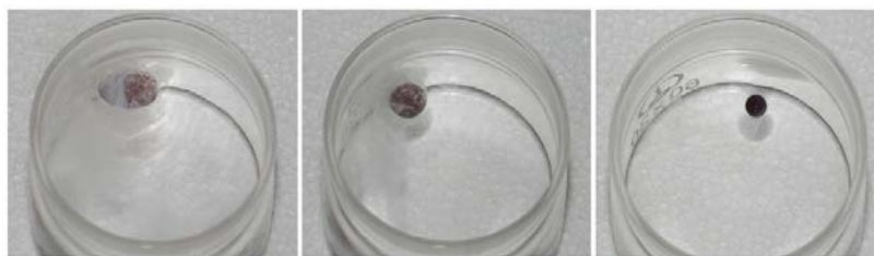
Рис. 3. Слева направо представлена динамика изменения формы и размера капли коллоида золотых наночастиц, полученных в жидком азоте на поверхности этанола
