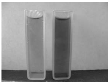
Рис. 4. Фотография демонстрирующая изменение цвета жидкости при лазерной абляции. Слева продукты лазерной абляции в дистиллированной воде, справа в спирте
