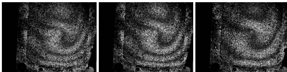
Рис. 7. Характерный вид интерферограммы температурной деформации поверхности пластины с дефектом в виде лунки на обратной стороне
