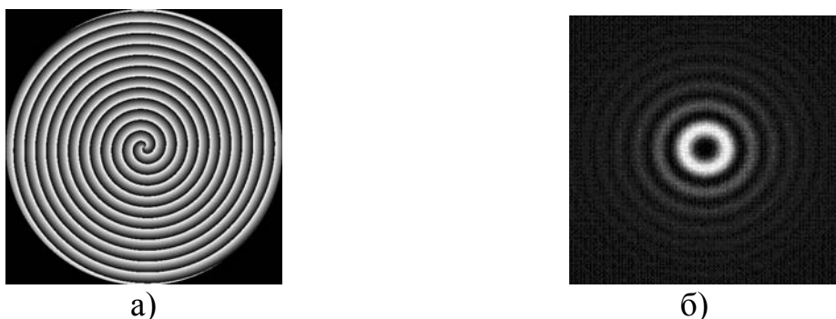
Рис. 4. а) фазовый профиль вихревого аксикона ( m=2 ), б) распределение интенсивности, формируемое с его помощью в фокусе линзы (численный расчет)
