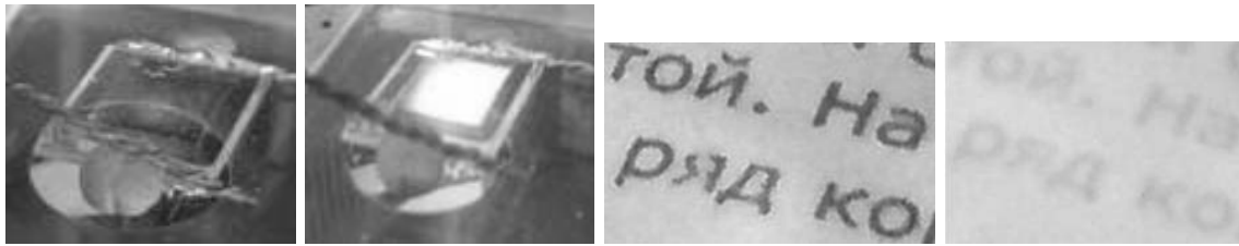
Рис.7. Модулятор рассеяния света, выполненный на смектической наноструктуре СЖК-576, толщина слоя СЖК - 30 \mu\text{м} , шаг спирали r_0=165 нм. Слева направо: прозрачное состояние модулятора (управляющее напряжение выключено), модулятор работает в режиме переходного рассеяния, прозрачное состояние модулятора (управляющее напряжение выключено), модулятор работает в режиме переходного рассеяния на частоте 450 Гц (прозрачное и рассеивающее состояния модулятора чередуются через равные интервалы времени)
