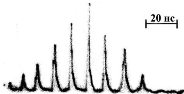
Рис. 5. Характерная осциллограмма генерации задающего лазера в режиме КРМП
