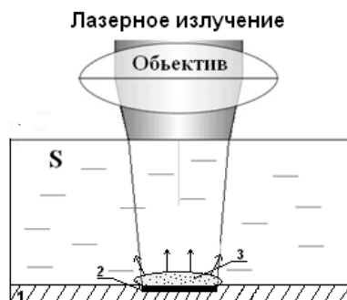
Рис. 2. Схематичное изображение процесса лазерной абляции в жидкости, 1-образец, 2-зона расплава, 3-парогазовое облако, S-жидкость
