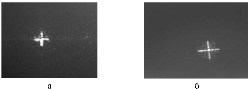
Рис. 1. Экспериментально полученные распределения интенсивности при использовании: бинарного пространственного модулятора света (а), элемента, изготовленного на стекле (б)
