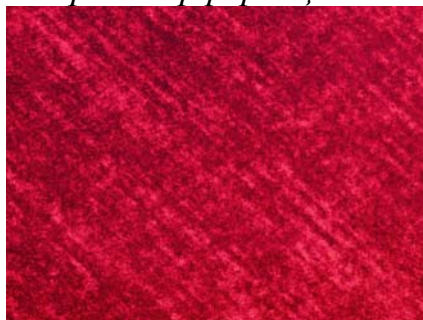
Рис. 5. Пример интерференционной картины (перемещение объекта в горизонтальной плоскости)
