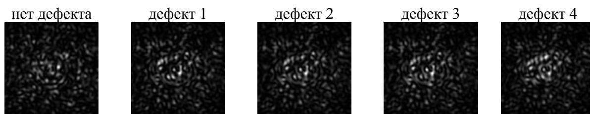
Рис. 1. Распределение интенсивности поля спирального пучка в плоскости регистрации
