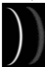
Рис. 4. Теоретическое (слева) и экспериментальное (справа) распределение интенсивности в пучке-полумесяце
