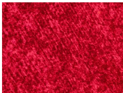
Рис. 6. Пример интерференционной картины (перемещение объекта в вертикальной плоскости)
