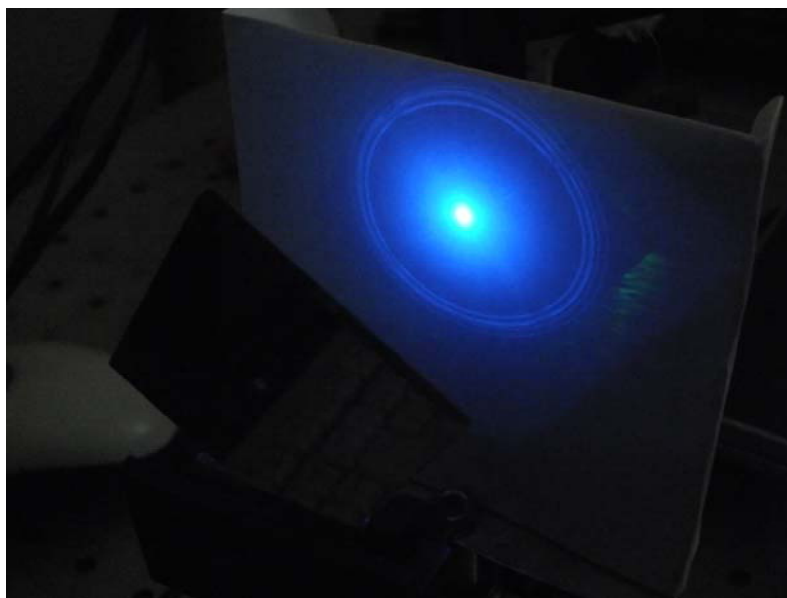
Рис. 2. Результат фокусировки амплитудного фокусатора в кольцо. Для удобства наблюдения изображение показано на расстоянии, превышающее фокусное
