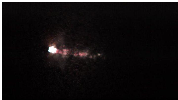
Рис.2. Фотография распространения плазменного канала от анода в жидкости с объемным содержанием микропузырьков 3%. t = 3537 мкс.
