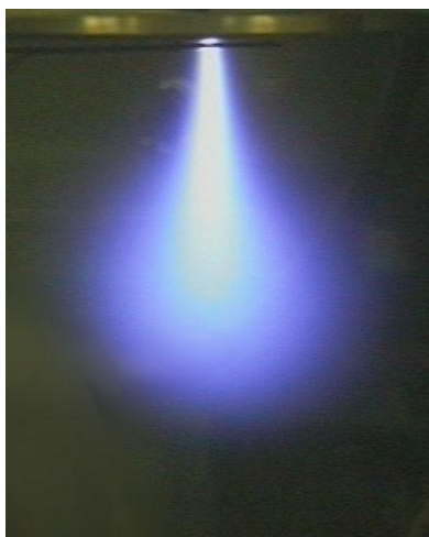
Рис. 4. Электронный пучок, выведенный в воздушную атмосферу
