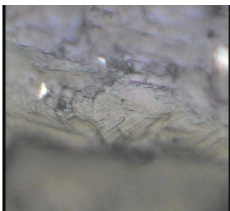
Рис.4. Оптическая фотография рельефа образца, полученного при 350 Торр гелия, 400А, его расходе 0,75 г/с. Расход ацетилена составил 0,1 г/с.
