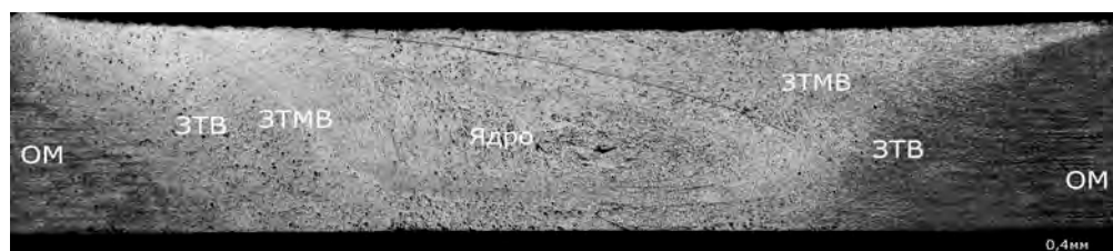
Рис.3. Макроструктура шлифа поперечного сечения СТП соединения
