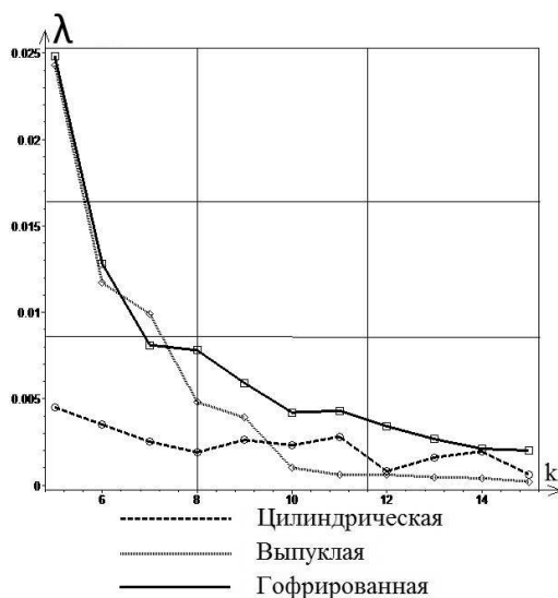
Рисунок 2 – Зависимость первых критических значений в зависимости от параметра волнообразования
