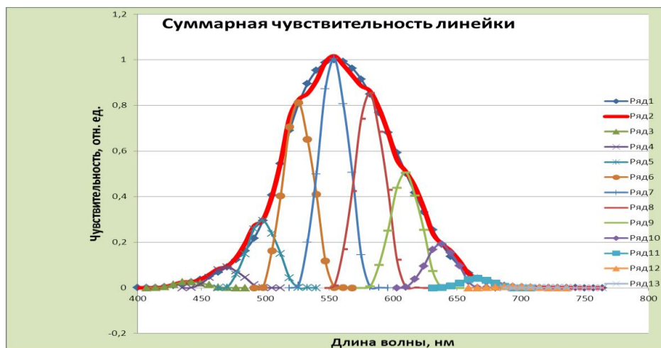
Рис. 5. Приведение спектральной чувствительности фотодиодной линейки к виду относительной световой эффективности глаза V(\lambda) .
