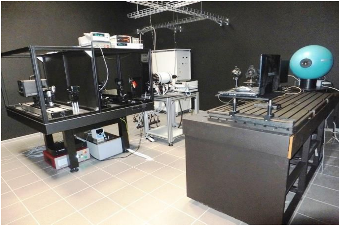
Рисунок 1. Внешний вид установки ГПЭ для воспроизведения единицы силы света малых уровней.
