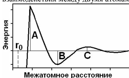
Рис. 1. Схематическое изображение потенциала непрямого взаимодействия (обусловленного наличием поверхностных электронов) между двумя атомами на поверхности (111) [4].
