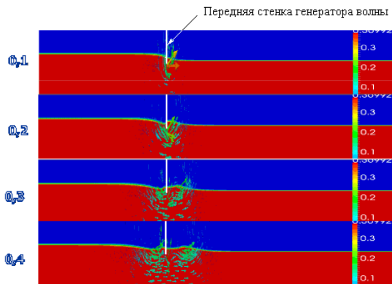
Рис.7. Результаты расчета поля скоростей вблизи передней стенки генератора волны в начальные моменты времени от 0.1 до 0.4 с.
