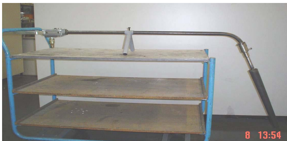
Рис.10. Погружной жезл системы Contilance.
