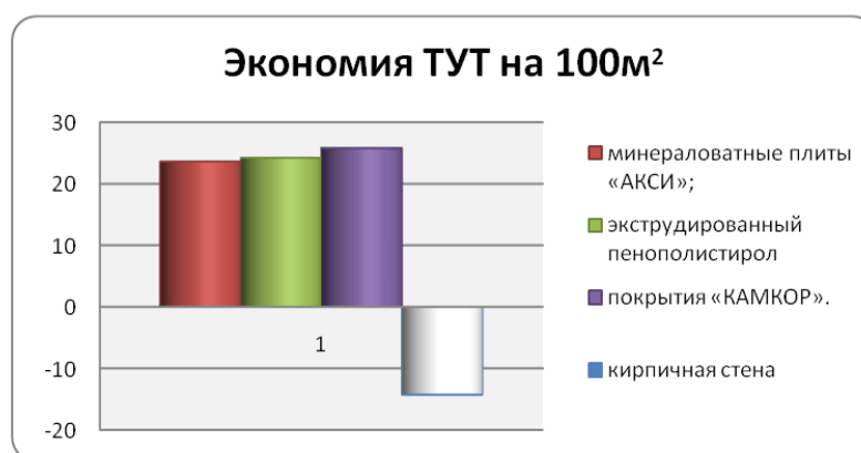
Рисунок 4 – Экономия тепла в пересчете в ТУТ при применении теплоизоляционных материалов для кирпичной стенки
