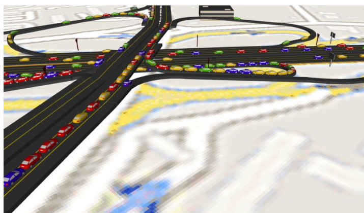
Рис. 5. Затопы на модели дорожной развязки со стороны ул. Заки Валиди
