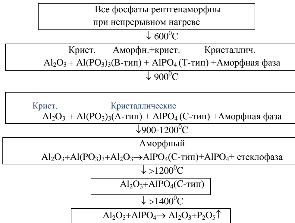
Рис.3 Схема основных термических превращений в системе \alpha\text{-Al}_2\text{O}_3\text{-H}_3\text{PO}_4 (Т:Ж=2:1)
