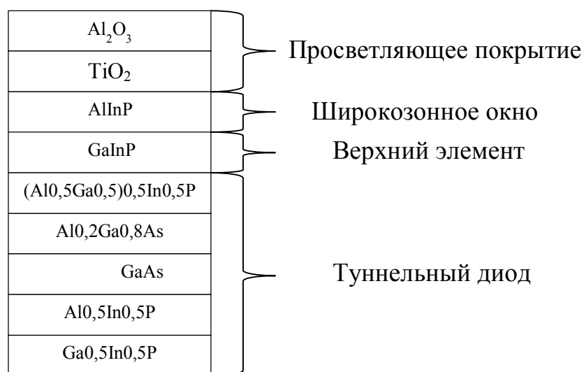
Рис. 1. Структура просветляющего покрытия для трехкаскадного ФП.
