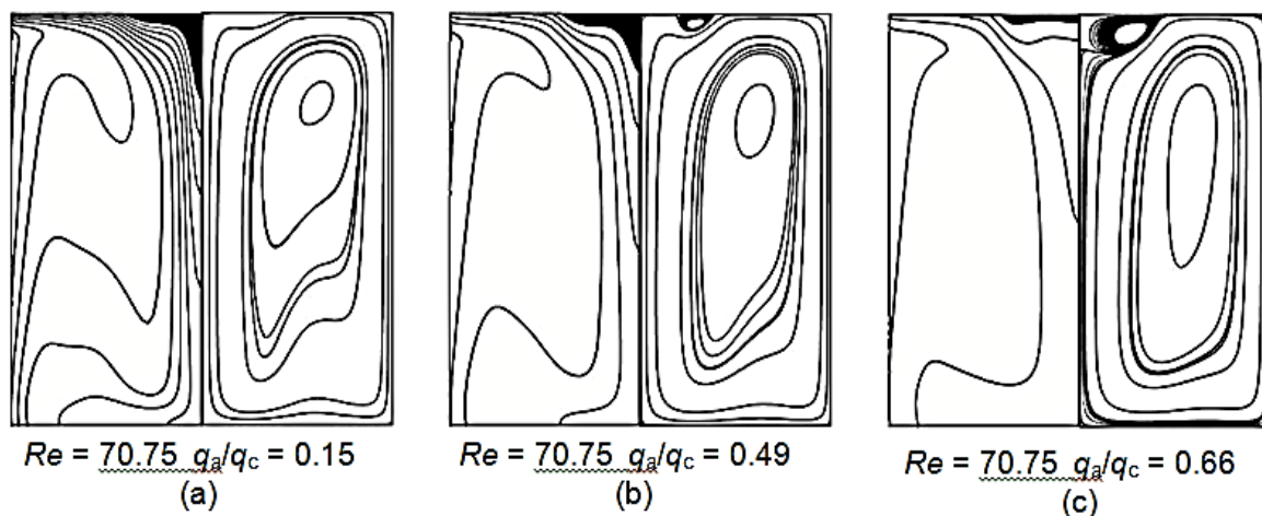
Рис.2. Изотермы и конвективные линии тока по левую и правую сторону от оси симметрии, соответственно, при различных соотношениях q_a/q_c . Разность температур между соседними изотермами составляет 15 К. Зачерненные области представляют изотермы плавления
