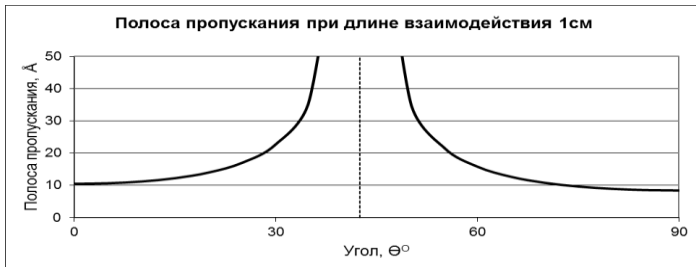
Рис. 2. Полоса пропускания при коллинеарном взаимодействии в плоскости N_p N_g
