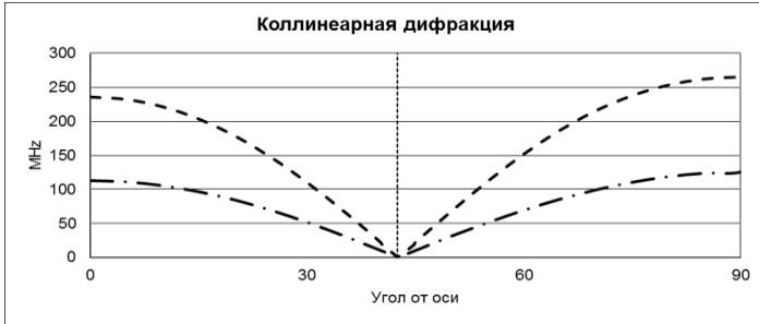
Рис. 1. Частота коллинеарной дифракции при взаимодействии в плоскости N_p N_g
