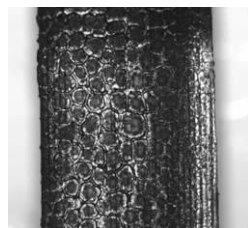
Рис. 1. Поверхность обработанной лазером ленты (x10)
