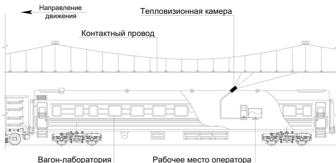
*Рис. 1. Вагон-лаборатория для получения тепловых изображений контактной сети*
