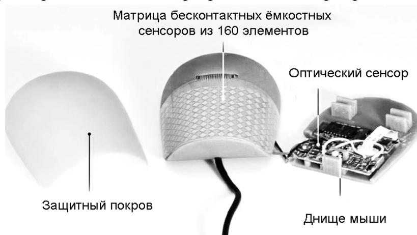
Рис. 1. Microsoft® Cap® манипулятор типа «мышь», реагирующий на нажатие
