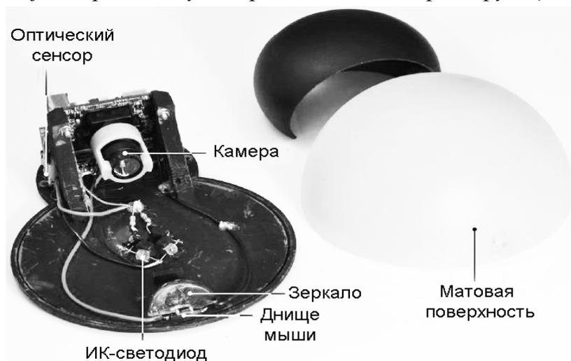
Рис. 2. Microsoft® Orb® манипулятор типа «мышь», реагирующий на касание
