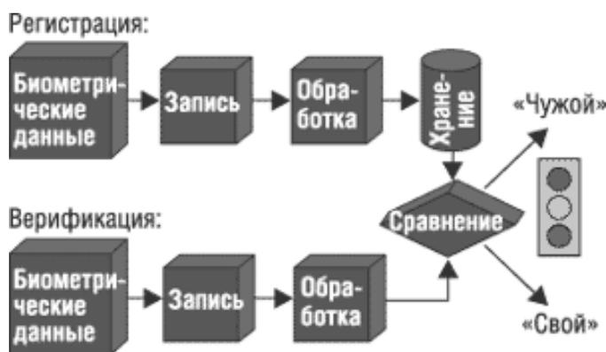
Рис. 1. Блок-схема биометрической системы
