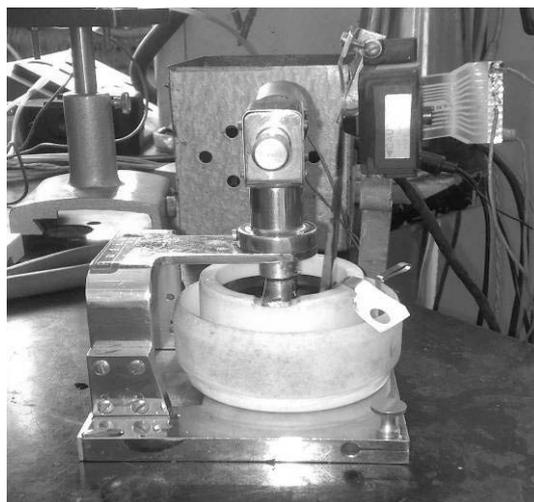
Рис. 1. Устройство для получения пористого кремния: а) схема устройства: 1 – катод; 2 – фторопластовая трубка; 3 – электролит; 4 – уплотнитель; 5 – кремниевая пластина; б – контактная площадка из нержавеющей стали; б) фото устройства
