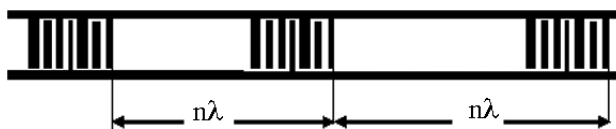
Рис. 5. Топология прореженного однонаправленного ВШП
