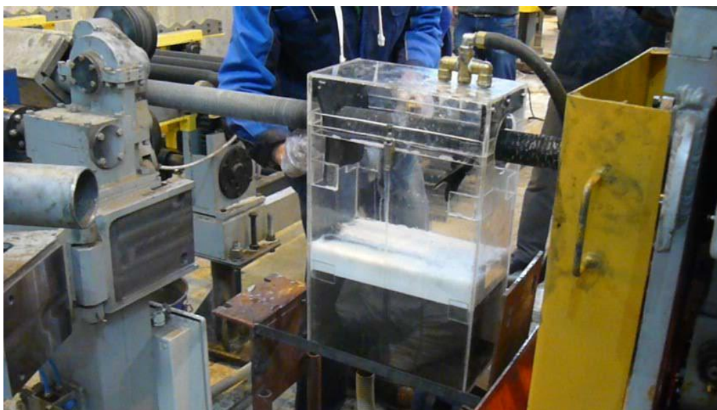
Рисунок 4 - Испытания узла очистки оребренных труб
