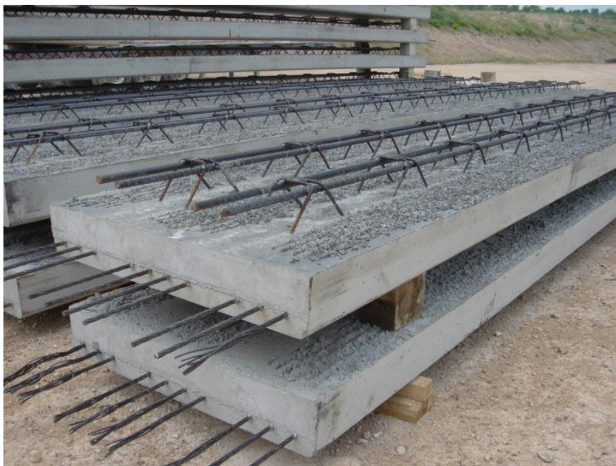
Железобетонные плиты заводского изготовления
