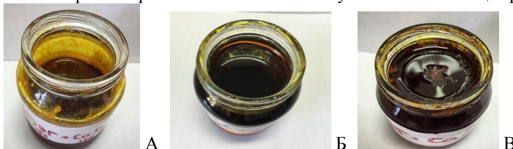
Рис.1 (А) полисульфид кальция полученный в среде диэтиленгликоля (ДЭГ),
