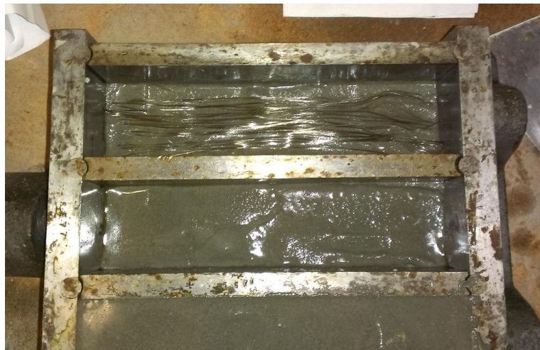
Рис.1 Укладка базальтового волокна
