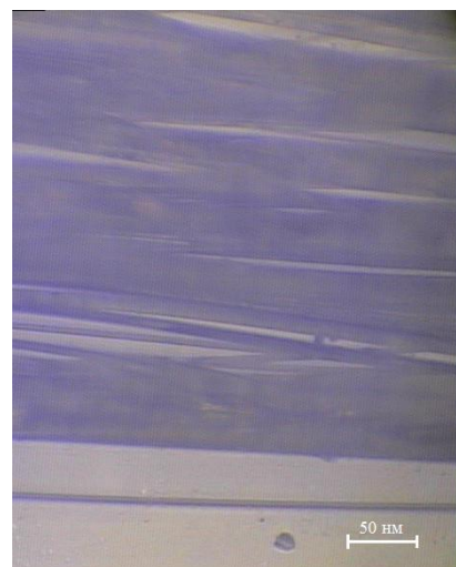
Рис. 3 Разрушение базальтовых волокон при выдергивании. Образец с количеством фибры 0,39 г – а, конфокальное микроскопическое изображение ровинга(часть волокон остались неразрушенными) – б
