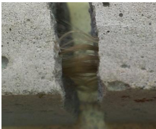
Рис. 3 Разрушение базальтовых волокон при выдергивании. Образец с количеством фибры 0,39 г – а, конфокальное микроскопическое изображение ровинга(часть волокон остались неразрушенными) – б
