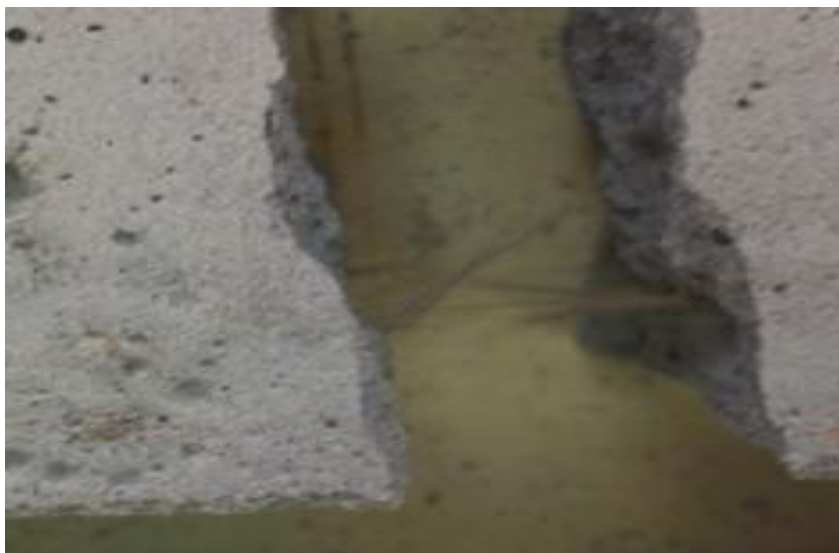
Рис. 2 Разрушение базальтовых волокон при выдергивании. Образец с количеством фибры 0,17
