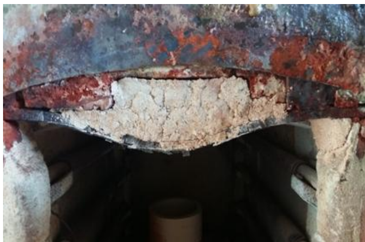
Рис.1 Элемент камерной высокотемпературной печи, отремонтированный высокотемпературной обмазочной массой
