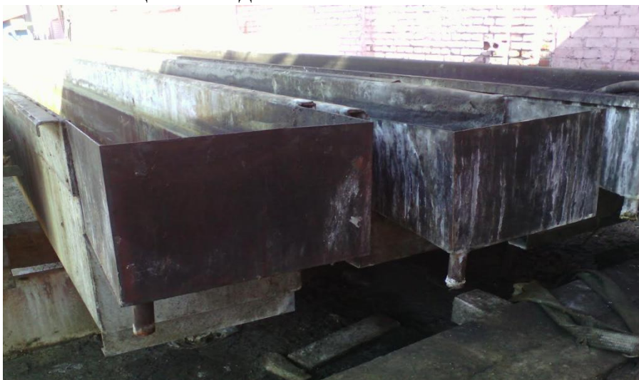
Рис. 1. - Барботажные ванны, используемые для очистки оребренных труб.
