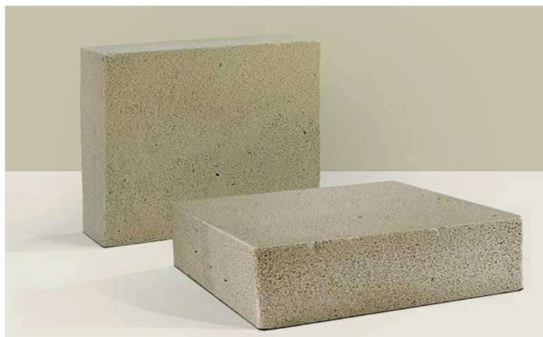
Рис. 2. Пенокерамические блоки из алюмосиликатов
