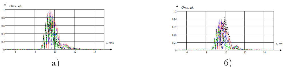
Рис. 5. Импульсные отклики датчика при погружении в бензин и раствор бензин–спирт (2:1):
