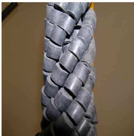
Рис.6. Макет регулярной укладки активных элементов в реакторах.
