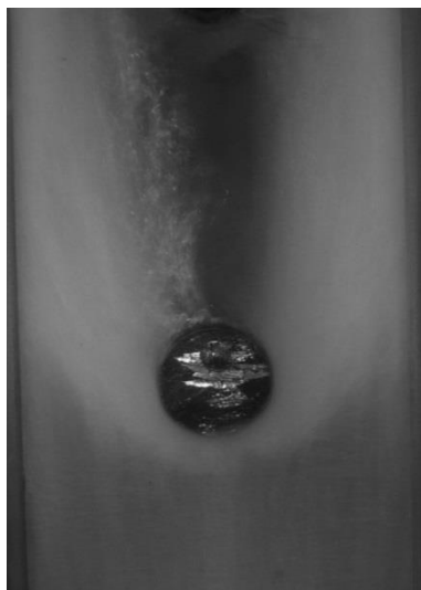
Рис.4. Визуализация фронта ударной волны [16,17]. Диаметр цилиндра 6 мм. Поток направлен снизу вверх.
