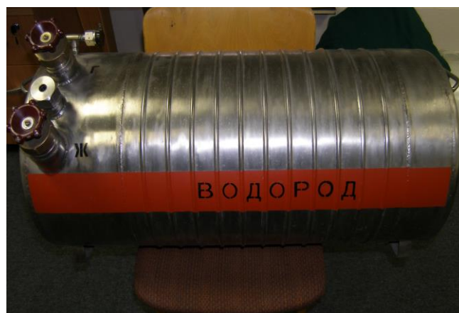
Рис.4. Криогенный съемный бак, изготовленный по оригинальной теплоизоляционной технологии Струминского В.В. Масса заправляемого водорода – 2.5 кг. Вес бака – 25 кг. Объем – 40 литров. Суточная испаряемость 8 %.
