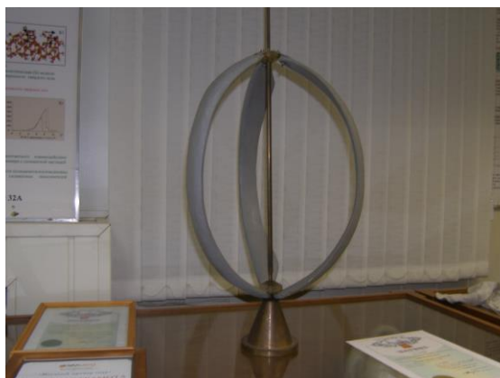
Рис.5. Макет лопастей, разработанных Струминским В.В., для оригинальной модели ветроагрегата.
