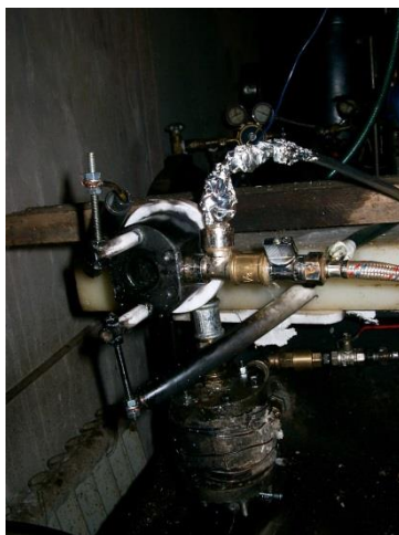
Рис.10. Внешний вид модернизированного устройства для распыления и поджига композитного топлива.
