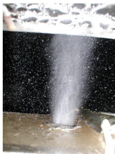
Рис.13. Истечение струи барботированной воды.
