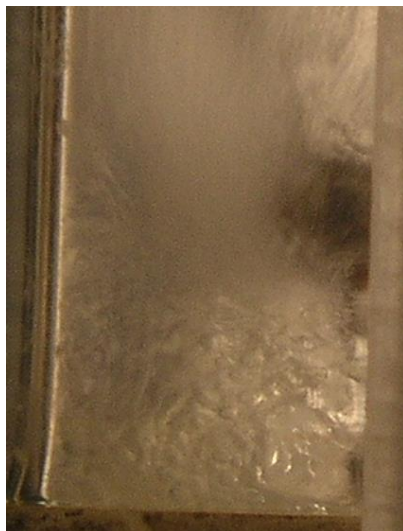
Рис.3. Фотография ударной волны в газожидкостном потоке. Поток направлен снизу вверх. Препятствие справа.
