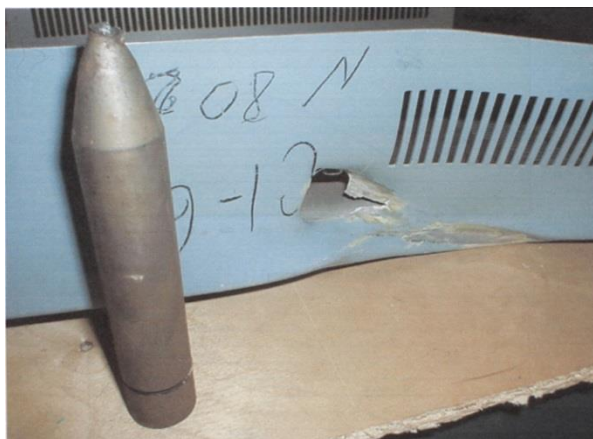
Рис.12. РМЭ после безоткатного пуска из короткоствольного беззатворного МУ-20.
