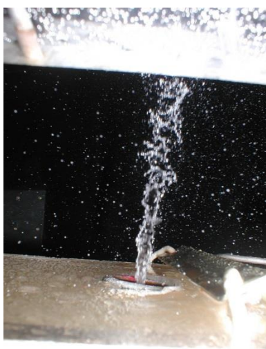
Рис.12. Истечение струи небарботированной воды.
