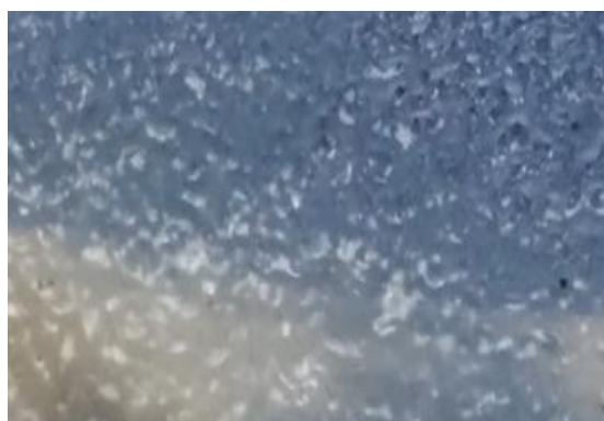
Рис.1. Нанесенное покрытие с предварительной обработкой раствором полимера
