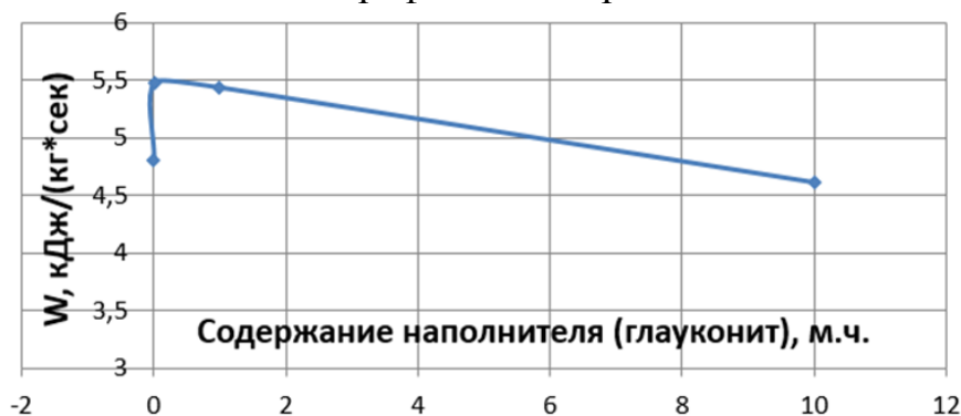
Рис. 2. Концентрационные зависимости удельной скорости поглощения энергии образцов СВМПЭ + глауконит от содержания наполнителя.
