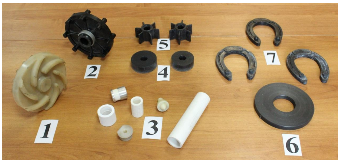
Рис. 6. Изделия из СВМПЭ-композитов, полученные твердофазной объемной штамповкой: 1 – рабочее колесо центробежного насоса; 2 – рабочее колесо привода снегохода «Рысь»; 3 – детали механоактиватора моторного топлива; 4 – заготовки для штамповки рабочего колеса жидкостнокольцевого вакуумнасоса; 5 – рабочие колеса жидкостнокольцевого вакуумнасоса; 6- заготовка для штамповки подковы рысистых лошадей; 7 – подковы для рысистых лошадей.
