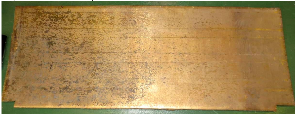
Рис. 1. Лист термометалла 36Н+Л63 размером 6х300х800 мм.
