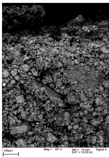
Рис.3 Микрофотография разреза приповерхностной области образца.
