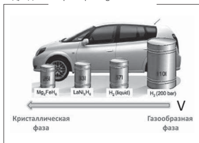
Рис. 1 - Наглядная демонстрация компактности хранения водорода с использованием твердотельных комплексных гидридов на примере Mg_2FeH_6 и LaNi_5H_6
