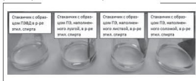
Рис. 14 – Сравнение результатов после выдержки образцов в растворе этилового спирта
