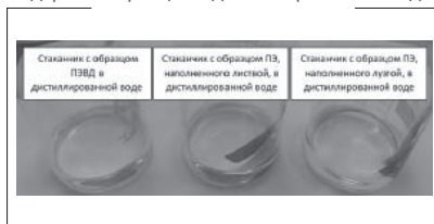
Рис. 14 – Сравнение результатов после выдержки образцов в растворе этилового спирта
