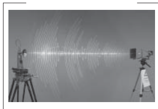
Рис. 7 - Измеренная диаграмма направленности облучателя в Н-плоскости
