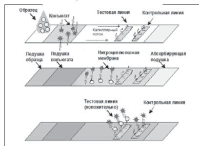
Рис. 1 - Нитроцеллюлозная тест-полоска с аптамерами
